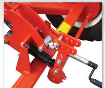
Sistema de travagem com comando hidráulico
