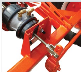
Sistema de travagem com comando pneumático
